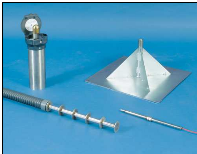
FIGURA 4 Assestimetro a piastra
