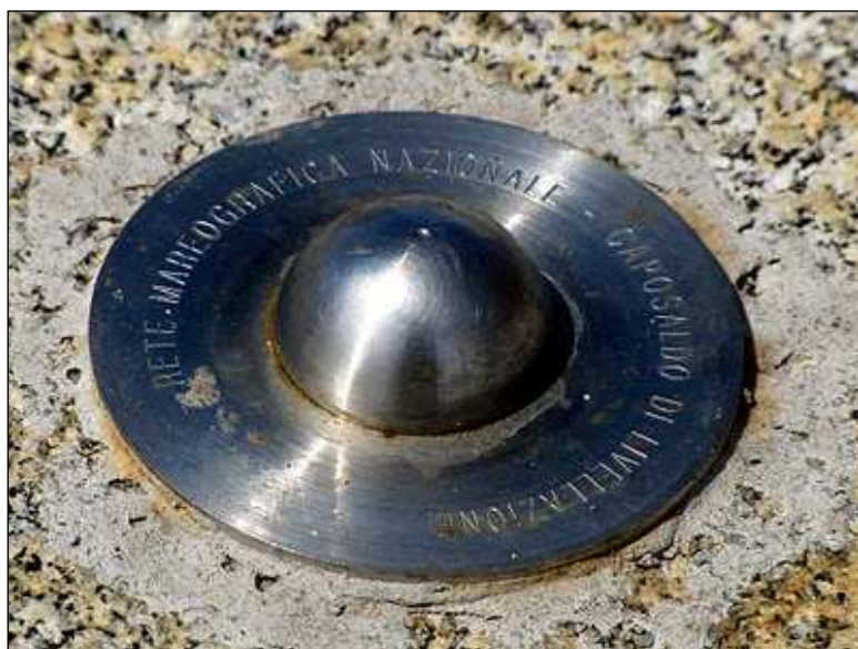
FIGURA 3 Esempio di caposaldo con testa a borchia.
